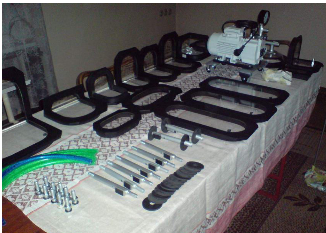
Sortiment pomôcok ku skúšanju zvarov s vákuovými komôrkami
