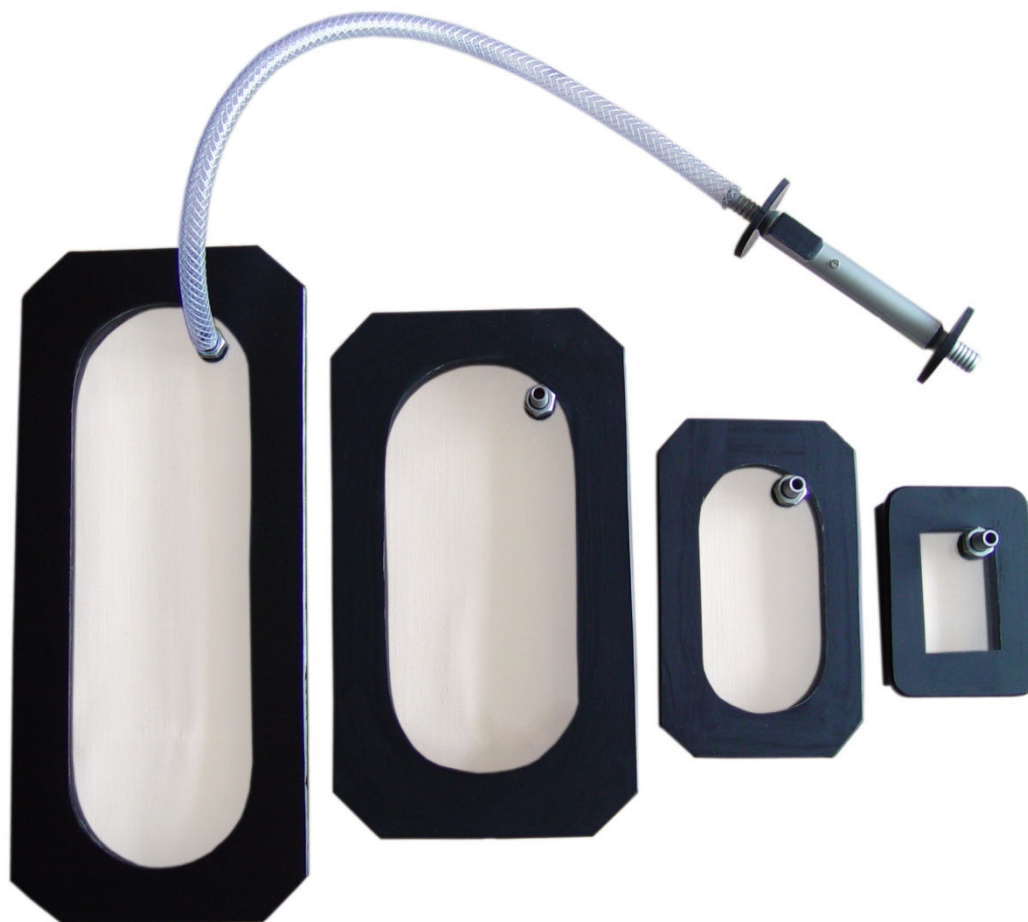
Dispozícia skúšky tesnosti pomocou vákuovej komôrky
