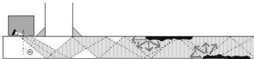
Obr.12 –Schematické zobrazenie použitia metodiky LORUS na dňach nádrží
