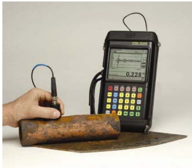
Obr.3 - Meranie pomocou sondy EMAT a hrúbkomeřa 37 DL Plus fy R/D TECH
