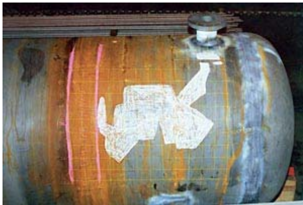
Obr. 20 – Schéma merania a mapovanie korózie dna nádrže v petrochemickom priemysle.
