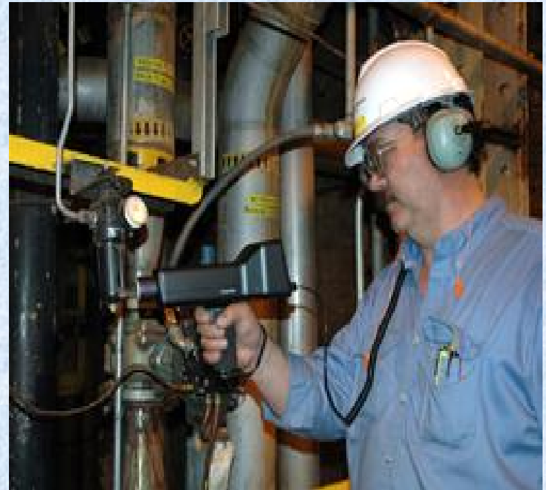
Obr. 11.6 Kontrola tesnosti pomocou ultrazvukového detektoru netesností
