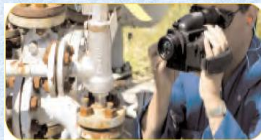
Obr. 11.3 Nasadenie termovíznej kamery GasFindIR FLIR pri kontrole potrubí v petrochemickej prevádzke
