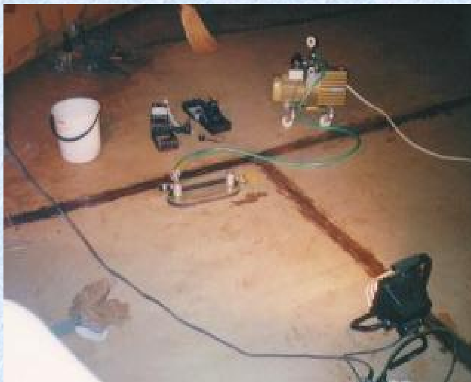
Obr. 4.4 Kontrola tesnosti zvarov dna veľkoobjemovej nádrže pomocou vákuovej komôrky. Zdrojom vákua je rotačná olejová výveva.
