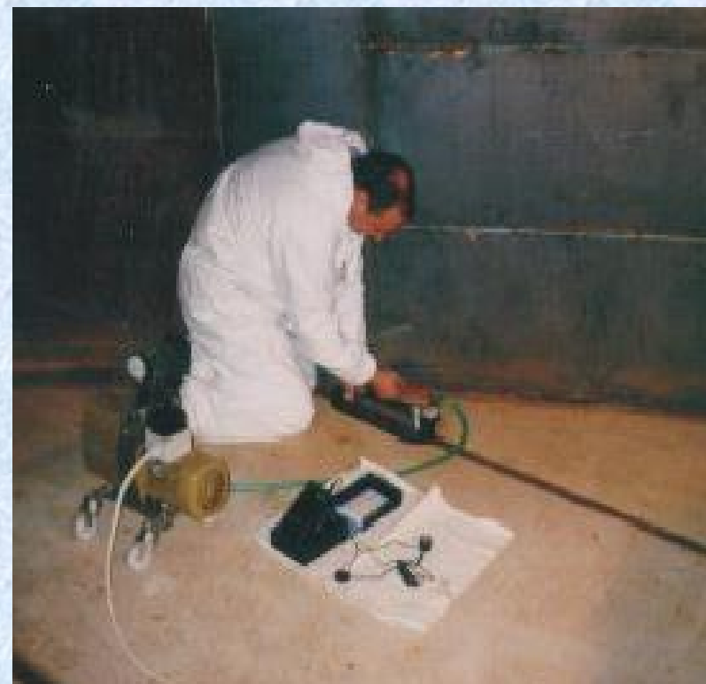
Obr. 4.4 Kontrola tesnosti zvarov dna veľkoobjemovej nádrže pomocou vákuovej komôrky. Zdrojom vákua je rotačná olejová výveva.
