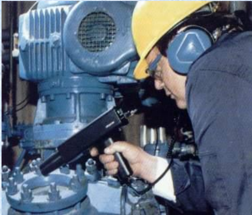
Obr. 11.6 Kontrola tesnosti pomocou ultrazvukového detektoru netesností
