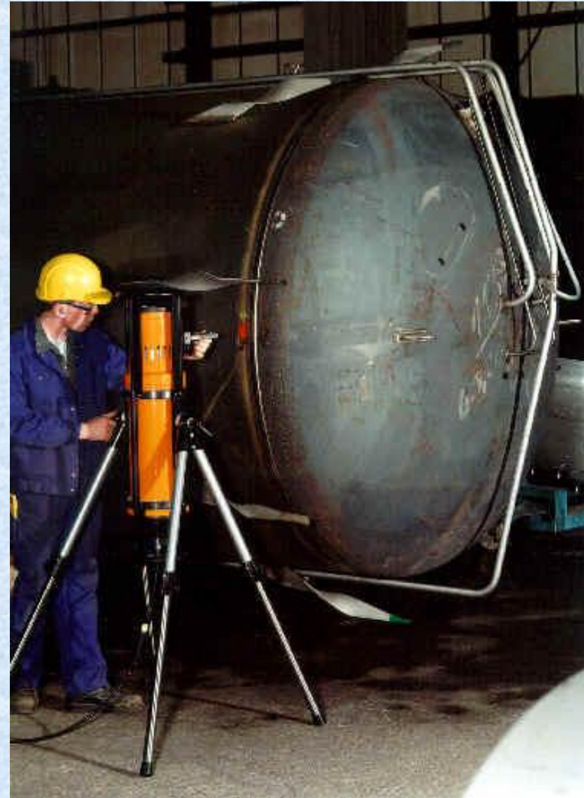
Obr. 2.1.2 Prežarovanie zvaru na valcovej nádrži ↑
