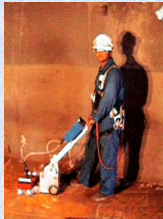
Obr. 11.2 Skenovanie dna vo veľkoobjemovej nádrži
