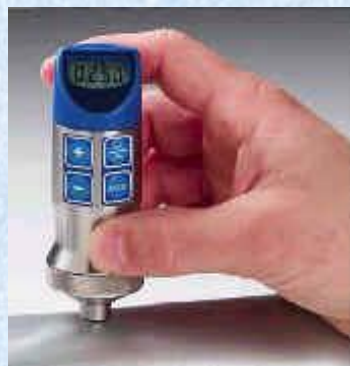
Obr. 2.2.1 Princíp merania hrúbky pomocou ultrazvuku ( UTT )
