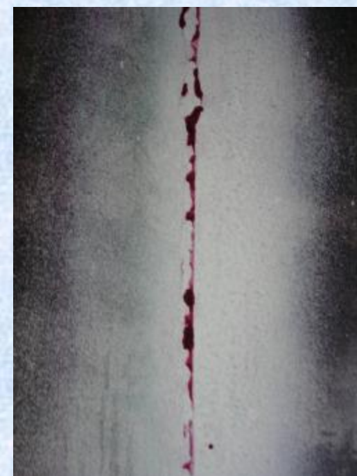
Obr. 2.3.2 PT prípravky a zvar po PT kontrole
