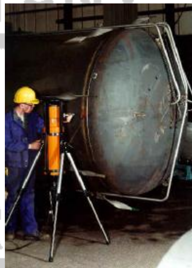
Obr. 2.1.2 Prežarovanie zvaru na valcovej nádrži
