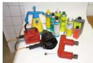
Obr. 2.4.2 Prístroje a prípravky na MT
