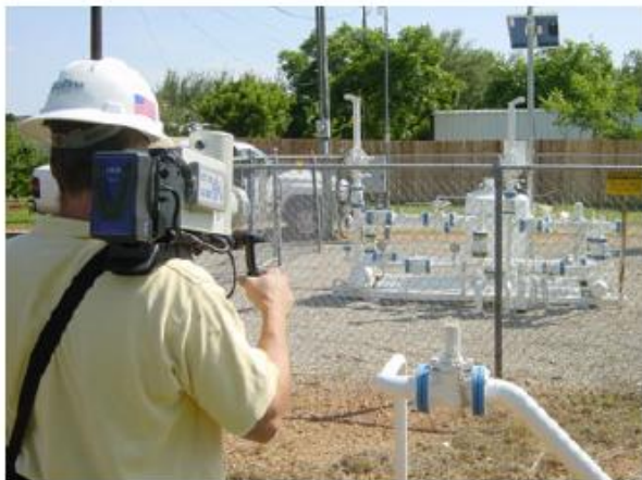
Obr. 11.3 Nasadenie termovíznej kamery GasFindIR FLIR pri kontrole potrubí v petrochemickej prevádzke
