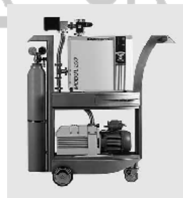
Obr. 2.6.2 Prístroje a prípravky na LT; vľavo skúška zmenou tlaku, vpravo He hľadač
