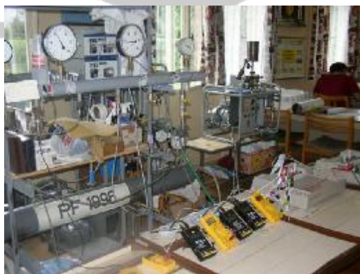
Obr. 2.6.2 Prístroje a prípravky na LT; vľavo skúška zmenou tlaku, vpravo He hľadač
