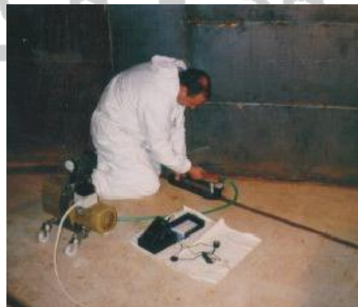
Obr. 4.4 Kontrola tesnosti zvarov dna veľkoobjemovej nádrže pomocou vákuovej komôrky. Zdrojom vákuua je rotačná olejová výveva.
