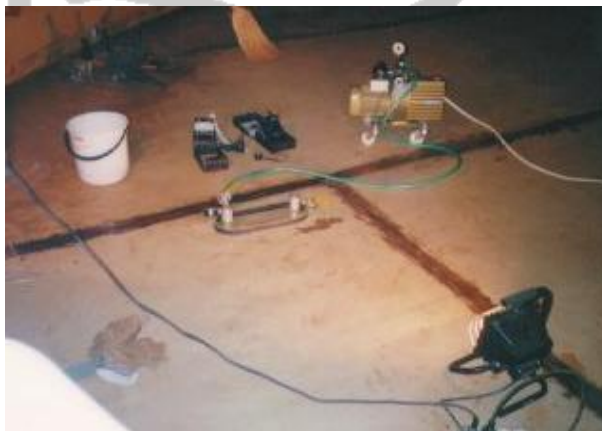
Obr. 4.4 Kontrola tesnosti zvarov dna veľkoobjemovej nádrže pomocou vákuovej komôrky. Zdrojom vákuua je rotačná olejová výveva.
