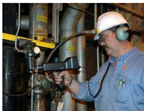
Obr. 11.6 Kontrola tesnosti pomocou ultrazvukového detektora netesností
