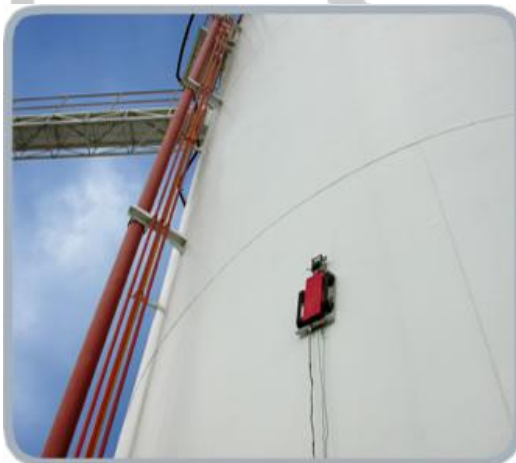
Obr. 2.2.3 UT skener na nádrži
