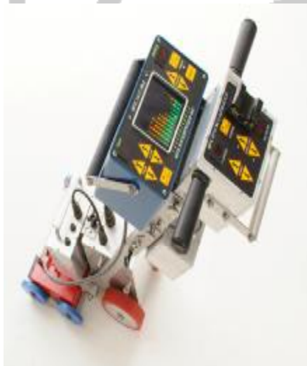
Obr. 11.1 Skener na dno veľkoobjemovej nádrže
