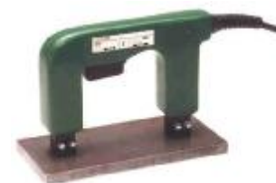
Obr. 2.4.2 Prístroje a prípravky na MT
