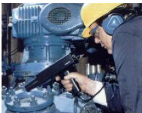
Obr. 11.6 Kontrola tesnosti pomocou ultrazvukového detektora netesností
